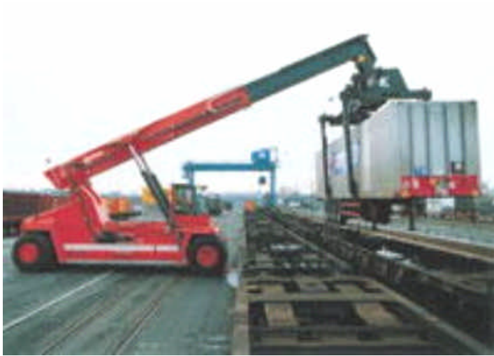
Figur 5 Reach Stackers med topplyftok för lyft av semitrailer
