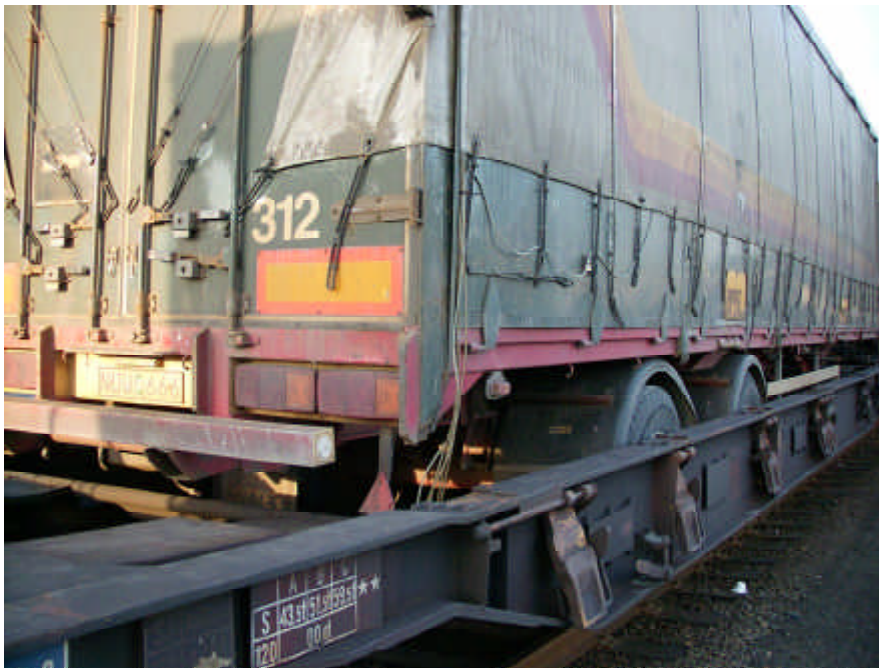
Figur 6 Semitrailer i kombivagn för lyft på och av vagnen. På sidan av vagnen ses de låskonor på vilka container placeras när de vikts upp ovanpå sidobalkarna
