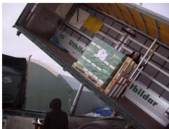
Fältstudier, rangerprov respektive lutningsprov, med palletiserat gods i Malmö 2006-02-23 respektive i Helsingborg 2006-02-28.
