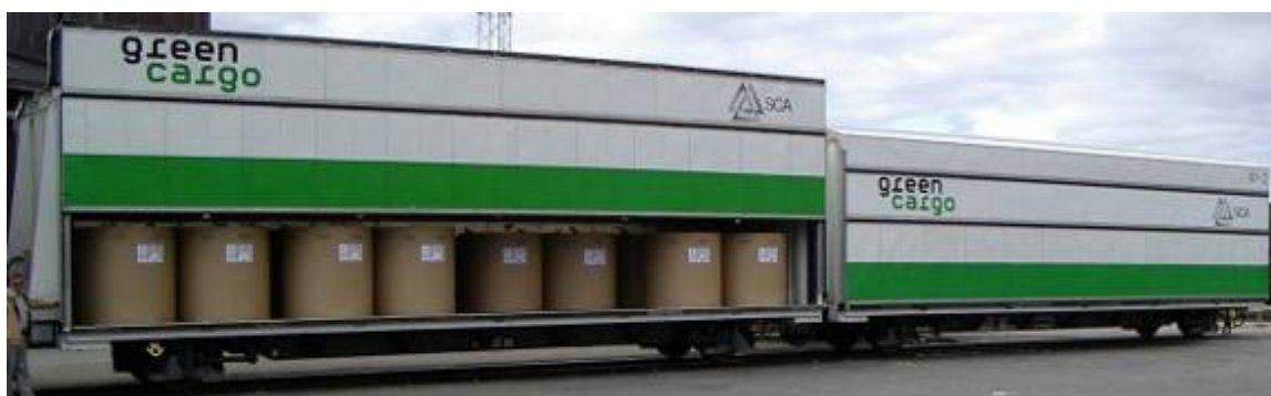
Ny godsvagn med modernt löpverk som eliminerar onödiga rörelser och förbättrar transportmiljön.
