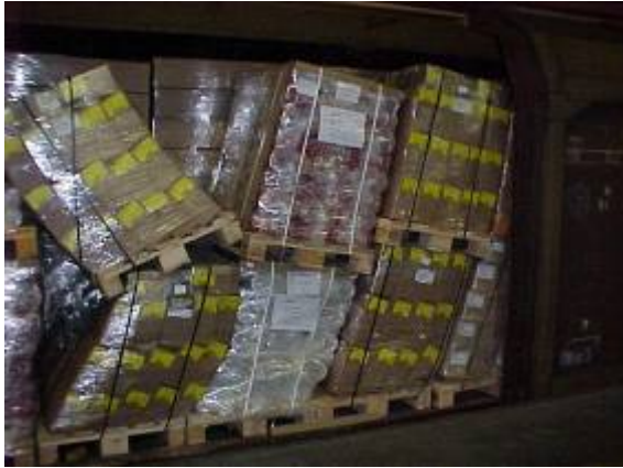
Godsskador, bräckage, orsakade av rängering och vibrationer, är vanligt förekommande vid järnvägstransport. Skadorna kan förhoppningsvis reduceras tack vare resultaten av de nya forskningsrönen.
