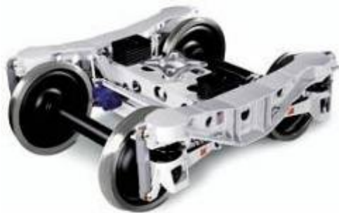
Modernt löpverk och långslagig stötinrättning med glidande topp för bättre transportmiljö vid järnvägstransport
